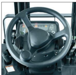
Lo sterzo completamente idrostatico
