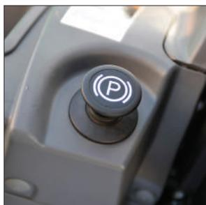
Il freno di stazionamento controllato elettronicamente
