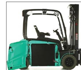
Telaio per la sostituzione laterale della batteria
