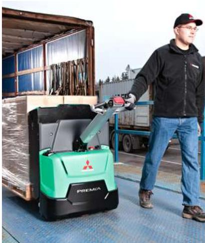
I modelli PREMIA ES hanno un telaio eccezionalmente corto per lavorare in corridoi molto stretti, consentendo la massima densità di stoccaggio. L'altezza di sollevamento leader di mercato e le ruote di stabilizzazione collegate garantiscono stabilità durante l'impiego su rampe, banchine di carico e superfici irregolari.
